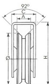
Roda para portões correr com suporte externo com 1 rolamento - Canal em V
